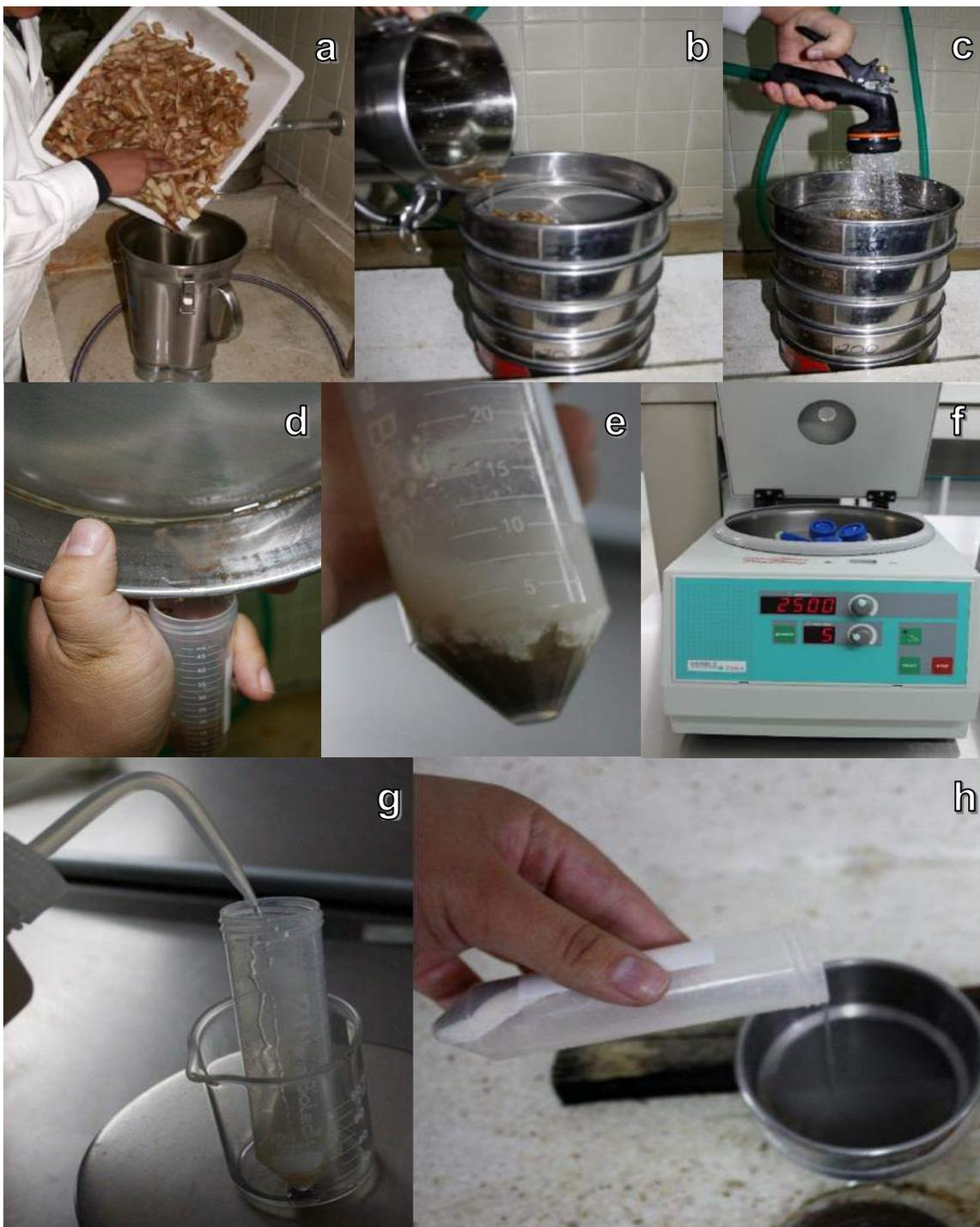
**Figura 6. Procedimiento de extracción de nematodos:** a). Macerado de muestra en licuadora; b). Vertido de macerado sobre tamices; c). Lavado y tamizado de muestra; d). Colecta de tamizado 450 mallas; e). Mezcla de tamizado con caolín; f). Centrifugado; g). Agregando solución azucarada, y h). Decantado y lavado de extracto de nematodos.
